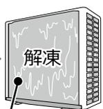
霜を溶かして、熱交換器の汚れを洗い流します
