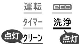
リモコンを操作してもクリーン運転ができないときは「ピピー」と鳴り、洗淨ランプが点滅します (1秒点灯/1秒消灯 約10秒間) (→P.37)
