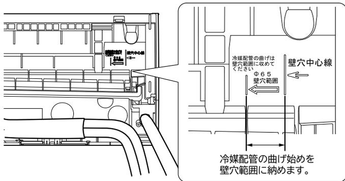
冷媒配管の曲げ始めが壁穴範囲から出ていたり、曲げRが大きいと室内機が壁から浮き上がり、仕上がりが悪くなる原因となります。
