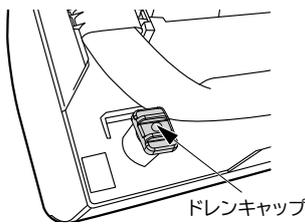
ドレン口先端に当たるまで押し込む。必ず目視で確認してください。
