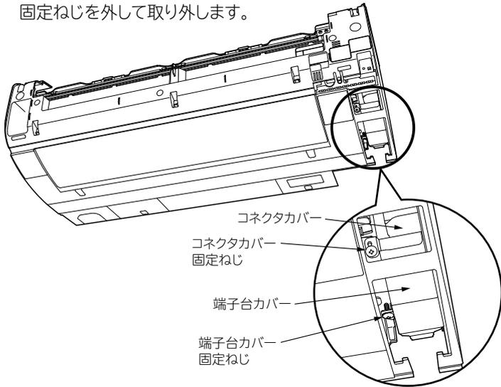
②HAシステムはCN6、RACアダプター・HEMSアダプター・無線LAN接続アダプターはコネクタをCN7に接続し、下図のように、ケーブルクリップで固定します。
