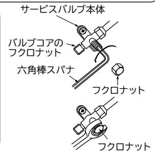
フクロナットは手締めでは冷媒漏れを防げません。スパナを使用してしっかり締め付けてください。
