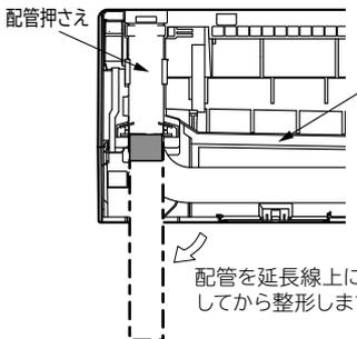
配管を延長線上に伸ばしてから整形します。
