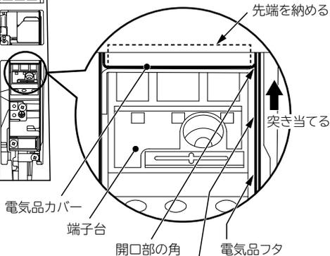
突き当てたときに先端部が電気品カバーに納まっていることを確認して固定ねじで取り付けます。
