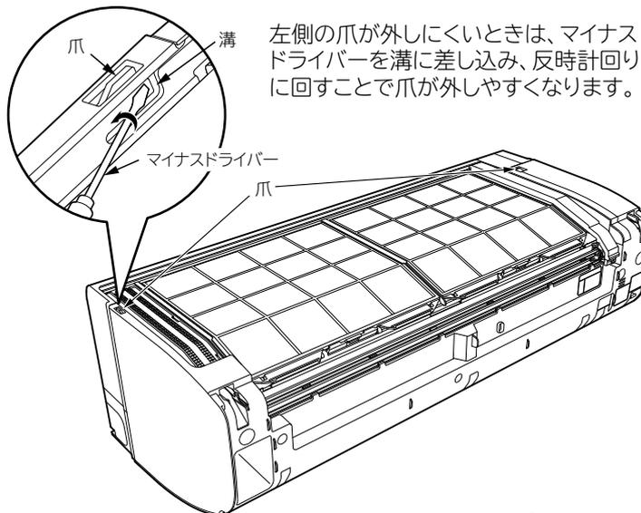
左側の爪が外しにくいときは、マイナスドライバーを溝に差し込み、反時計回りに回すことで爪が外しやすくなります。
