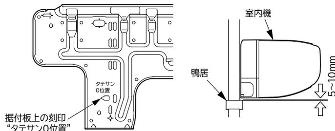
「たてさん」を使用して室内機の背面で冷媒配管を接続する場合は右図のように施行してください。
