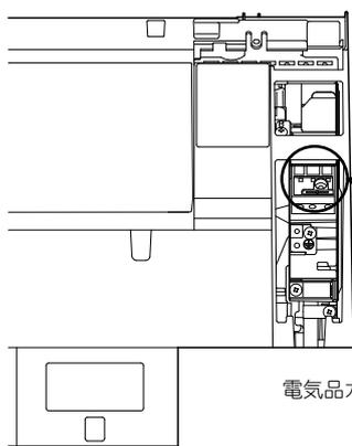
端子台カバー右上の切り欠きに電気品フタを差し込み、端子台カバーの先端が電気品カバーに納まるように開口部の角に突き当てます。
