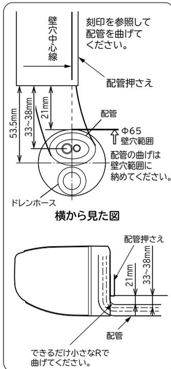
配管の曲げ始めが壁穴範囲から出ていたり、曲げRが大きいと、室内機が壁から浮き上がり、仕上りが悪くなる原因となります。
