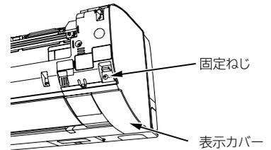
フロントパネルを閉めるときは、フロントパネルの左右2カ所を「カチッ」と音がするまで押し付けてください。最後に中央部を押してください。
