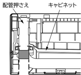
配管を延長線上に伸ばしてから整形します。
