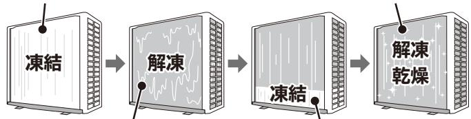
霜を溶かして、熱交換器の汚れを洗い流します
