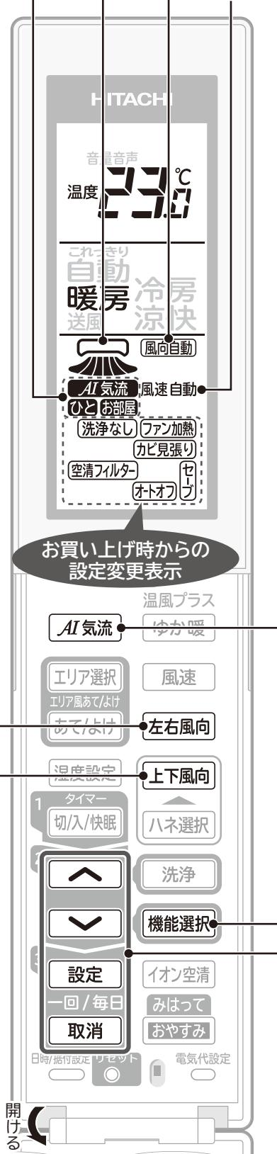
**AI気流 お部屋の状況にあわせて快適な気流に制御します →P.32**
