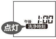
取り消す場合は [洗浄] を押して、クリーン運転開始時刻設定にしたあとリモコンを室内機に向けて [取消] を押してください
