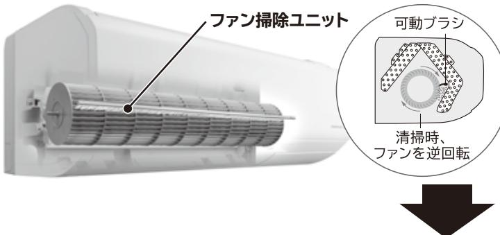
室内機のファンを可動ブラシで掃除するときに逆回転させることで、ファンから落としたホコリや汚れを熱交換器に付着させます。
