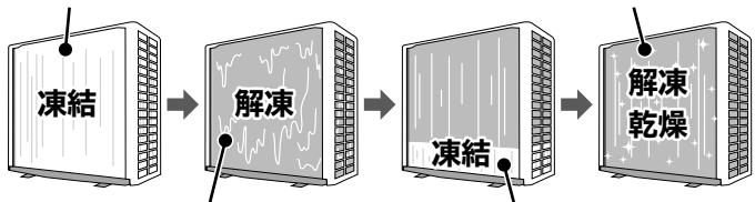
霜を溶かして、熱交換器の汚れを洗い流します
