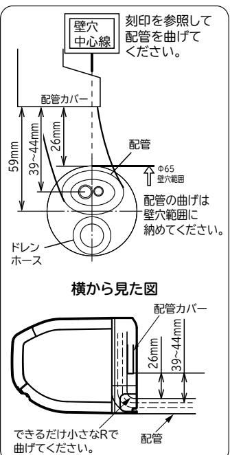
配管の曲げ始めが壁穴範囲から出ていると、曲げRが大きいと、室内機が壁から浮き上がり、仕上りが悪くなる原因となります。
