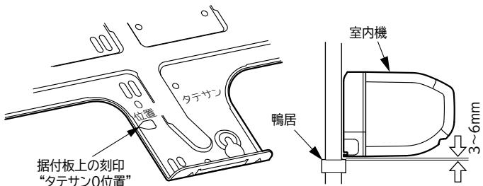
「たてさん」を使用して、室内機の背面で冷媒配管を接続する場合は、右の図のように施工してください。
