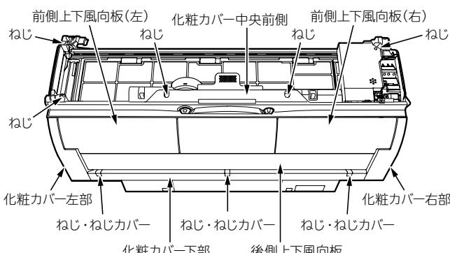
④ ねじ3本を外して、化粧カバー中央前側を外します。
