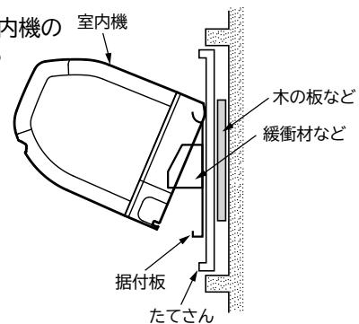
必ず、下図記載の刻印「-」部7箇所を付属ねじ7本で固定し、据え付け板は水平に固定する
