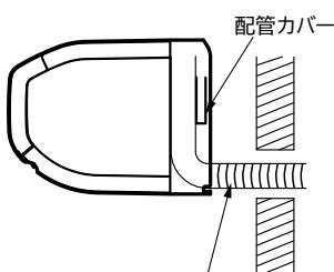
⑤ 壁穴に配管類を通します。テープを巻きます。
