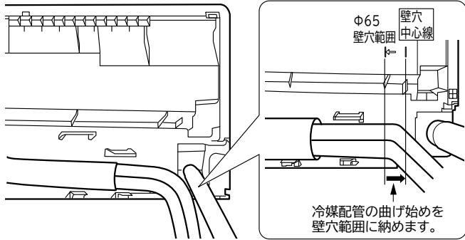
**冷媒配管の曲げ始めが壁穴範囲から出でていたり、曲げが大きいと室内機が壁から浮き上がり、仕上りが悪くなる原因となります。**
