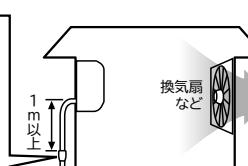
気密性の高い住宅などで強風時や換気扇を使用したときなどに、ドレン水がスムーズに流れず、異音(ポコポコ音など)が発生したり、水漏れが発生することがあります。
