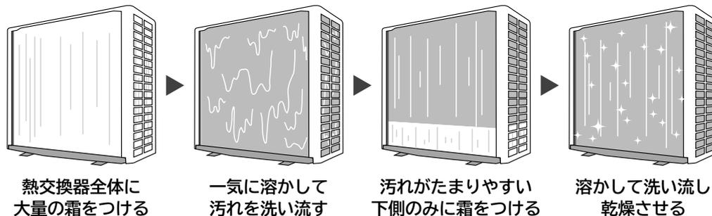
約10分以上運転して停止(イオン空清単独・送風運転は除く)したあとに、毎回室外機のファンを約3分間逆回転して、熱交換器のホコリなどを落とします
