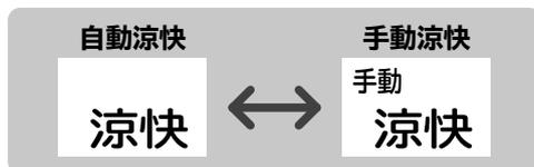
冷房運転では、お部屋の温度を下げて涼しくしますが、冷房運転とは異なり、湿度を下げて涼しくします。冷やし過ぎないので、手足の冷え過ぎを抑えられます。冷房の苦手な方におすすめです。
