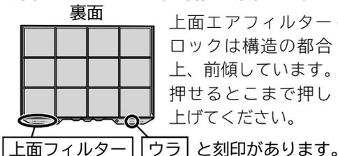
上面エアフィルターロックは構造の都合上、前傾しています。押せるまで押し上げてください。
