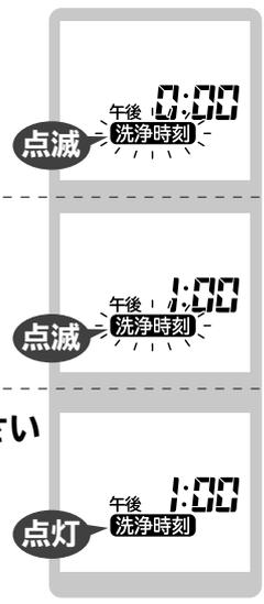
取り消す場合は **洗浄** を押して、クリーン運転開始時刻設定にしたあとリモコンを室内機に向けて **取消** を押してください
