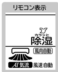
運転を開始すると「AI気流」が自動で設定され、風速が自動に変わりますが、変更できます。洗濯物の乾き具合を検知して洗濯物が乾いたと判断すると送風に運転を切り換えます。洗濯物などの位置・温度によっては、検知できないことがあります。
