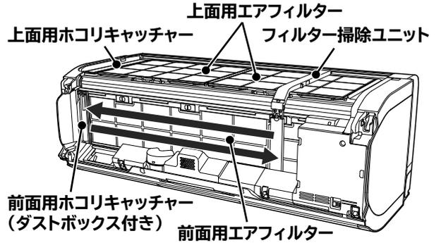
イラストは説明のため、フロントパネルを取り外しています。けがや故障の原因になりますのでフィルター掃除中はフロントパネルを開けたり、取り外したりしないでください。
