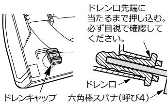
④ ドレンホースは、固定ねじの穴を合わせて突き当たるところまで確実に押し込み、①で外した固定ねじで固定してください。押し込むときは、ドレンホースの口元に水を塗ると差し込みやすくなります。
