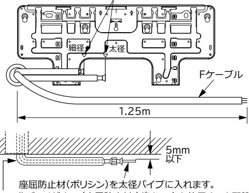
できるだけ小さなRで曲げてください (座屈防止材(ポリシン)を使用すると配管を潰さずに小さなRで曲げることができます)。Φ12.7(1/2インチ)のパイプはベンダーを使用すると配管を潰さずに小さなRで曲げられます。
