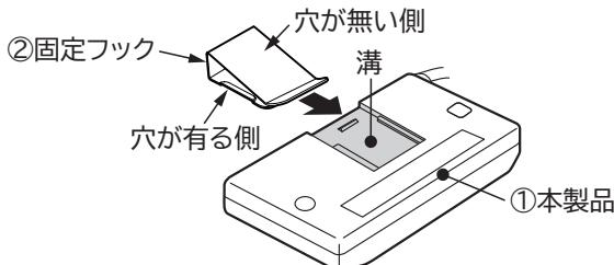
② ②固定フックを、穴が無い側を内側にして、下カバーの右側ブッシュ部（床側）を挟むように取り付ける。
