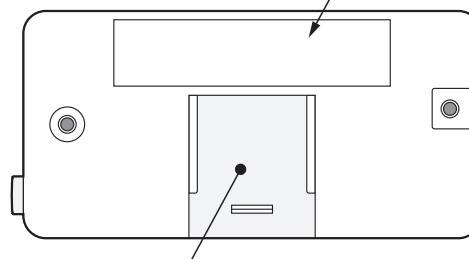
②固定フック・③壁付け用固定板取付部
