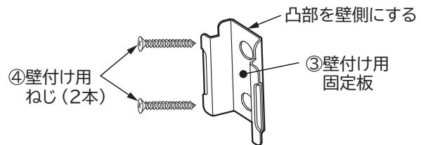
② ①本製品の溝に③壁付け用固定板を差し込んで取り付けてください。
