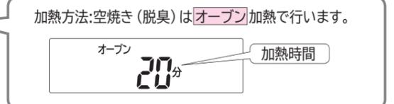
※空焼き終了後、冷却のためファンが約2分間回転し、冷却終了後自動停止します。
