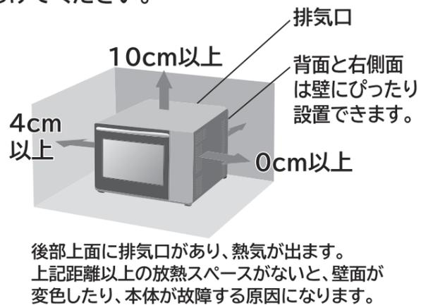
後部上面に排気口があり、熱気が出ます。上記距離以上の放熱スペースがないと、壁面が変色したり、本体が故障する原因になります。
