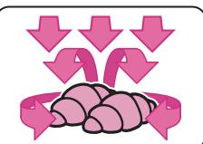
熱風ヒーターと上ヒーターで加熱室の温度を一定にするよう制御し、食品全体を包み込むようにして焼きます。
