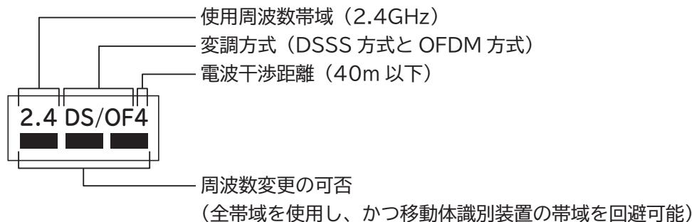
本製品の使用周波数帯では、電子レンジなどの産業・科学・医療機器のほか、工場製造ラインなどで使用されている移動体識別用の構内無線局(免許を要する無線局)及び特定小電力無線局(免許を要しない無線局)、ならびにアマチュア無線局(免許を要する無線局)が運用されています。
