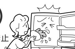
電気絶縁が低下し、感電・火災の恐れがあります。
