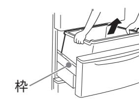
取り付けは、大物ケースの左右の突起を、枠の角穴に入れてセットする。
