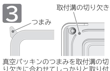
真空パッキンのつまみを取付溝の切り欠きに合わせてしっかりと取り付けてください。
