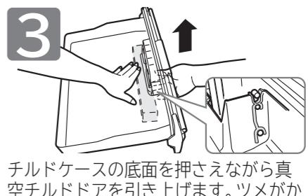
チルドケースの底面を押さえながら真空チルドドアを引き上げます。ツメがかかるていることを確認してください。
