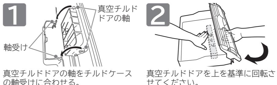
真空チルドドアの軸をチルドケースの軸受けに合わせる。
