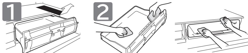
ドアを手前に引き出し、真空チルドケース(ドア付)の手前を軽く持ち上げて引き出します。
