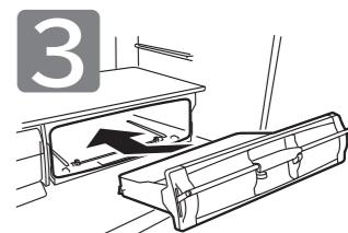
真空チルドケース(ドア付)を真空容器の中に滑らせるように入れてください。最後にハンドルのロックを下げてください。
