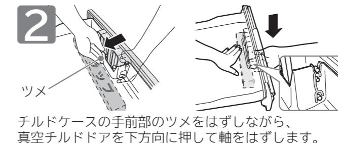
チルドケースの手前部のツメをはずしながら、真空チルドドアを下方に向けて軸をはずします。
