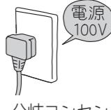
他の器具と併用すると、分岐コンセントが異常発熱して発火する原因になります。
