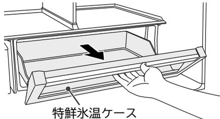
※冷蔵庫の左右のドアを両方開けずに特鮮氷温ケースを手前に引き出すと部品が破損することがあります。
