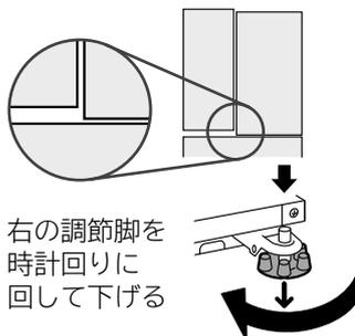
右の調節脚を時計回りに回して下げる
