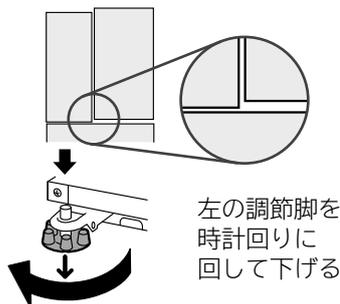
左の調節脚を時計回りに回して下げる
