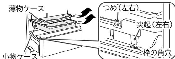
取り付けの際は、大物ケースの左右の突起を、枠の角穴に入れてセットしてください。また、小物ケース左右のつめを大物ケースの外側にセットしてください。
