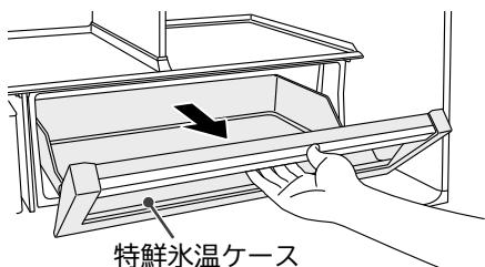
※冷蔵室の左右のドアを両方開けずに特鮮氷温ケースを手前に引き出すと部品が破損することがあります。
