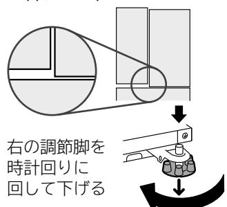
右の調節脚を時計回りに回して下げる
