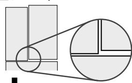
左の調節脚を時計回りに回して下げる
