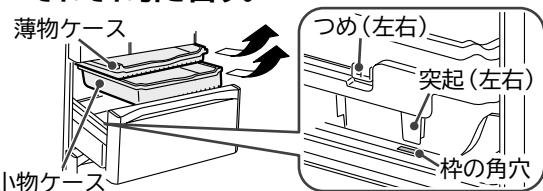
取り付けの際は、大物ケースの左右の突起を、枠の角穴に入れてセットしてください。
