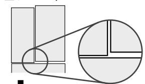
左の調節脚を時計回りに回して下げる
