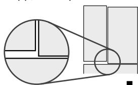
右の調節脚を時計回りに回して下げる
