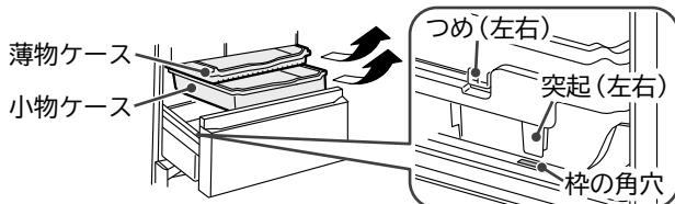
取り付けの際は、大物ケースの左右の突起を、枠の角穴に入れてセットしてください。また、小物ケース左右のつめを大物ケースの外側にセットしてください。
