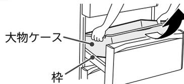
取り付けの際は、大物ケースの左右の突起を、枠の角穴に入れてセットしてください。また、小物ケース左右のつめを大物ケースの外側にセットしてください。
