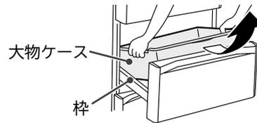
取り付けの際は、大物ケースの左右の突起を、枠の角穴に入れてセットしてください。また、小物ケース左右のつめを大物ケースの外側にセットしてください。
