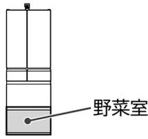
新鮮スリープ野菜室では、プラチナ触媒で炭酸ガスの濃度を高めて野菜の呼吸活動を抑え、眠らせるように、またうるおいユニットで適度な水分を維持して野菜を保存します。
