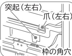
取り付けは、大物ケースの左右の突起を、枠の角穴に入れてセットする。また、小物ケース左右の爪を大物ケースの外側にセットする。
