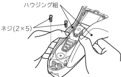
**8** ネジ(1.7×5)2本をはずし、矢印方向に引き抜きインナーハウジングをはずす。
