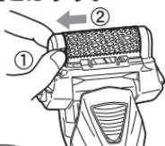
①内刃組取外しつまみを持ち、②矢印方向にまっすぐスライドさせると内刃組がはずれます。上方向への引張りは変形等により故障の原因となりますので注意してください。
