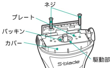
5 底カバーの $\oplus$ ネジ1本をはずして底カバーをはずし、電源部の $\oplus$ ネジ2本をはずす。
