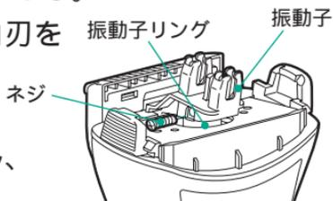
4 駆動部の $\oplus$ ネジ2本をはずし、プレート、パッキン、カバーをはずす。
