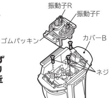
5 フロントパネルと⊕ネジ6本をはずし、本体から駆動部と電源部を取り出し、蓄電池のリード線を端子の近くで切り、蓄電池を取り出す。
