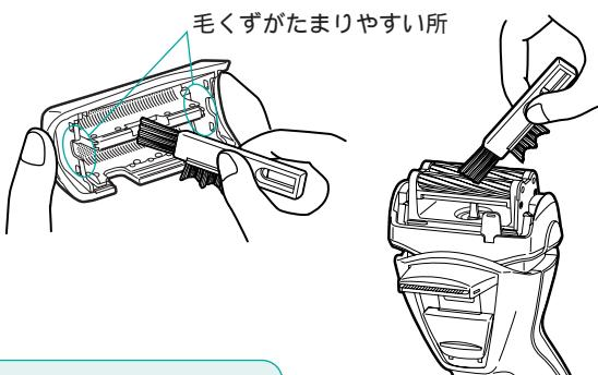
2 外刃、内刃、キワゾリ刃および本体を掃除する。特に外刃内側の両端は毛くずがたまりやすいので十分に掃除する。
