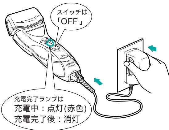
蓄電池が完全放電していると充電完了ランプが点灯しない場合があります。そのまま充電を続けますと充電完了ランプ点灯後に蓄電池への充電を開始します。
