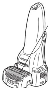
本体を水洗いした後、本体の外刃組を外し、外刃組を左図のようにスタンドキャップに置き、乾燥用スタンドとしてもご使用できます。
