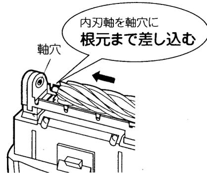
内刃軸が根元まで入らないときは内刃着脱つまみと取付け台の間に段差ができる
