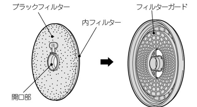
●フィルターセットをバックフィルターに取り付けます。
