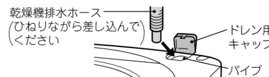
※1 洗濯機に排水ホースを接続する場合、蛇腹部を切断すると、排水ホースが外れ水漏れすることがあります。排水ホースはストレート部で切断してください。
