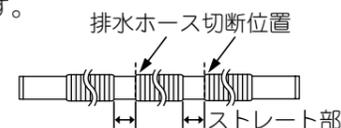
途中にたるみがあると排水できず、本体から水漏れすることがあります。排水ホース先端が排水配管に確実に差し込まれていないと水漏れするおそれがあります。
