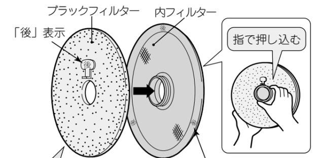
ブラックフィルターの向きを逆に「後」表示(各3ヶ所)に取り付けて運転すると、故障の原因になります。
