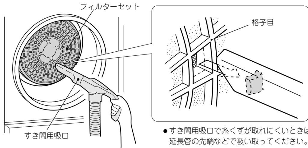
●すき間用吸口で糸くずが取れにくいときは、延長管の先端などで吸い取ってください。
