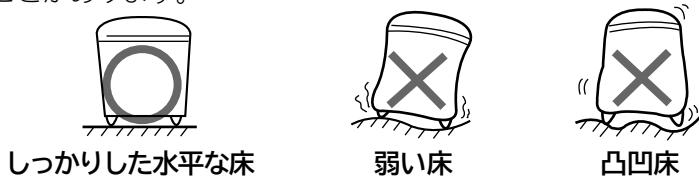
据え付け場所の床面が弱い(振動が気になる)場合には、別売りの補強板を設置してください。→(P.28)
