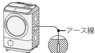
(電気工事士の有資格者がD種(第3種)接地工事をするよう、法令で定められています)
