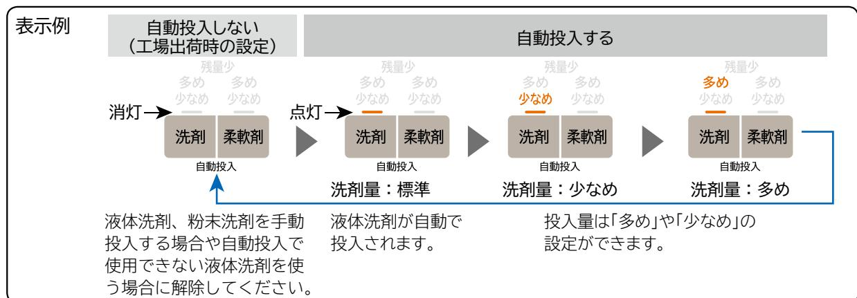
AIお洗濯設定時、液体洗剤の自動投入は「設定なし」と「設定あり」(洗剤量：標準)が設定できます。「設定あり」(洗剤量：多め・少なめ)は、自動で調整するため設定できません。**→(P.56)**
