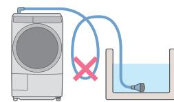
風呂水吸水口から浴槽水面までの高さは、1.2m以内にする
