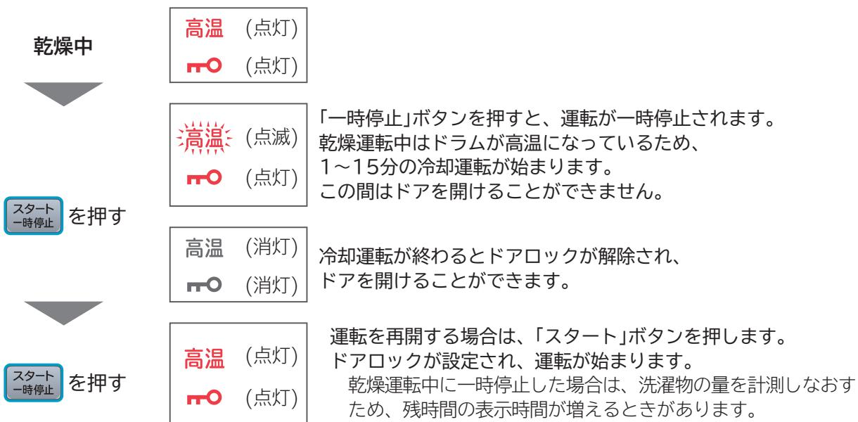
運転途中で電源を切ると、ドアロックが設定されたままの状態で運転が終了します。
