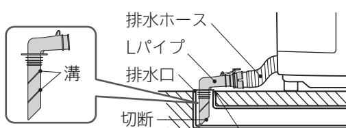
底とのすき間がない場合や、排水ホースが持ち上がる場合は、Lパイプの溝部を切断して調整してください。(切断面をなめらかに処理してご使用ください)
