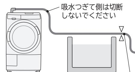
ホースの先端側を切斷して長さを調節してください
