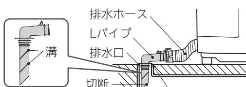
底とのすき間がない場合や、排水ホースが持ち上がる場合は、Lパイプの溝部を切断して調整してください。(切断面をなめらかに処理してご使用ください)
