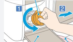
糸くずフィルターカバー 水受け 残水が出る場合があるので、水受けなどで受けてください。
