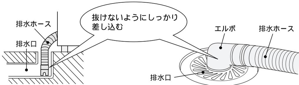
排水口が浅く、排水ホースの先端がぶつかるときは、排水ホースのくびれた部分を切断し、排水ホースの先端に付いているホースピースを付け替えてください。
