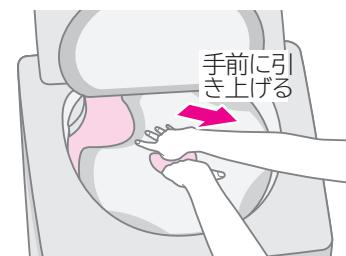
●取り付け・取り外しのときは、糸くずフィルターに当たらないように注意してください。
