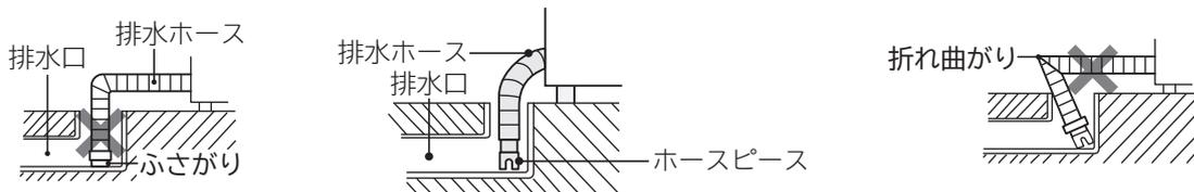
排水配管が見えない場合は、排水配管の位置を確認してから、排水ホース先端を差し込んでください。
