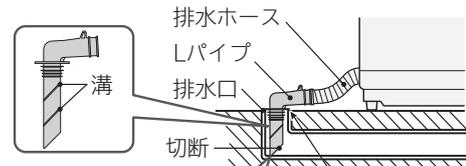
底とのすき間がない場合や、排水ホースが持ち上がる場合は、Lパイプの溝部をはさみやカッターなどで切断して調整してください。(切断面をなめらかに処理してご使用ください)
