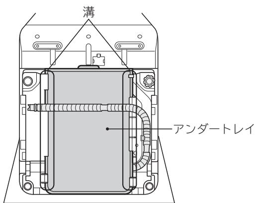
本体を水平に据え付けた状態でも付属品のアンダートレイを本体下部の溝(左右2か所)に合わせて取り外しができます。
