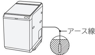
(電気工事士の有資格者がD種(第3種)接地工事をするよう、法令で定められています)
