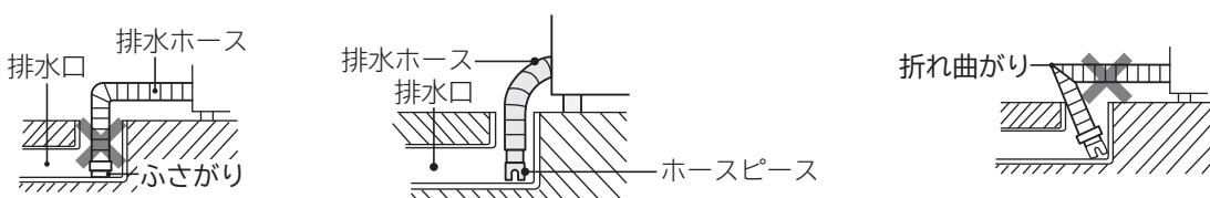
排水配管が見えない場合は、排水配管の位置を確認してから、排水ホース先端を差し込んでください。
