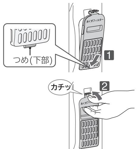
●糸くずフィルターを取り外したあとの洗濯・脱水槽の穴に、硬貨やヘアピンなどを落とさないように注意してください。
