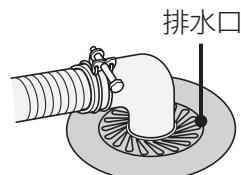
2 排水管内、排水口の中に残っている糸くずなどを取り除く
