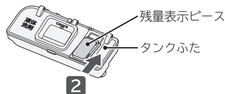
自動投入部ふた 3 液体洗剤タンクの場合は、左方向にスライドさせる
