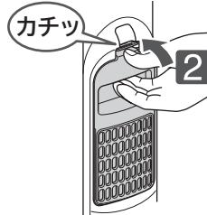
●糸くずフィルターを取り外したあとの洗濯・脱水槽の穴に、硬貨やヘアピンなどを落とさないように
