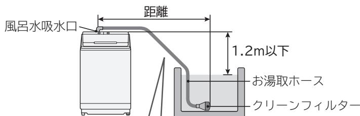
吸水中は、水の重さによりお湯取ホースが垂れ下がり、クリーンフィルターが浮き上がる場合がありますので、垂れ下がりを考慮してホースの長さを決めてください。
