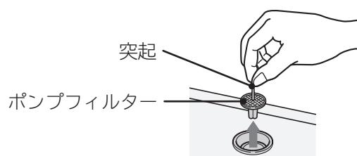
3 ポンプフィルターを風呂水吸水口に取り付ける
