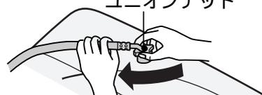
●ユニオンナットの締めつけが十分でないと、水漏れします。
