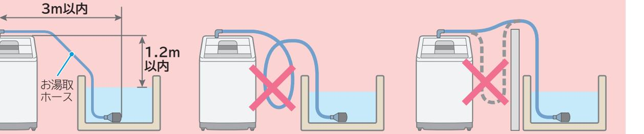
お湯取ホースは、風呂水吸水口からAg除菌お湯取ユニット先端までの距離が3m以内になるように設置してください。浴槽水面から風呂水吸水口までの高さは1.2m以内に設置してください。
