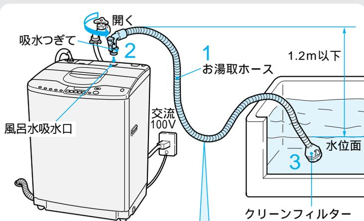
吸水中は、水の重さによりホースが垂れ下がり、クリーンフィルターが浮き上がる場合がありますので、垂れ下がりをご考慮してホースの長さを決めてください。
