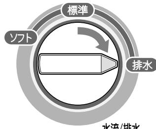
水流/排水切換を「排水」に合わせ排水します。
