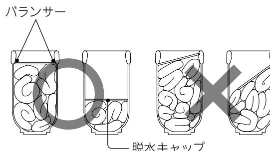
洗濯物を脱水槽に均等に入れ、脱水キャップをバランサーの内側に水平に入れます。
