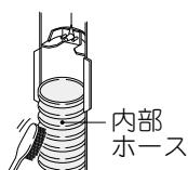
※内部ホースを清掃中に補強金具が外れた場合は、右図の位置に補強金具を差し込んで取り付けてください。
